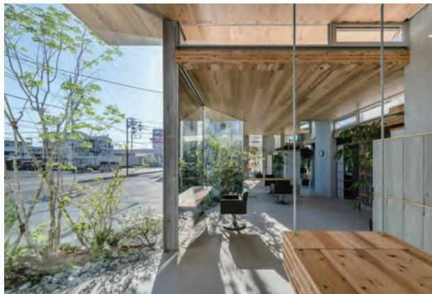
【講評】関東周辺のロードサイドに建つ美容院である。一見すると、床と壁だけが離散配置された、板によるミニマルな立体構成が印象に残る。同時に、その内部空間は美容室の機能に配慮した多様な空間になっていて、その水平方向のつながりは外部まで拡がっていくようだ。壁は RC、床は CLT と要求される機能に応じて材料を使い分け、接合部はまるで接着剤でくっつけたみたいにディテールが消されている。それは、何も見えないようにするために、壁内の配筋まで慎重に設計しているからこそミニマルさだ。設計者の意志は、ロードサイドのおだやかなシンボルとしてバランスよく現れている。このおだやかさとバランスのよさの先に、さらなる建築の強さを期待したい。（福島）
